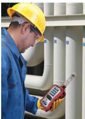
Использование прибора MultiRAE Benzene для обнаружения утечек
