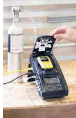
Для быстрой проверки устройства и сенсоров достаточно поместить детектор в доковый модуль. Данные легко передаются в компьютер для анализа, контроля соблюдения нормативных требований и настройки параметров.
