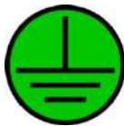
Рисунок 3. Точка защитного заземления
