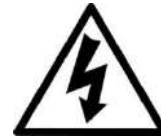
Рисунок 11. Опасность поражения электрическим током
