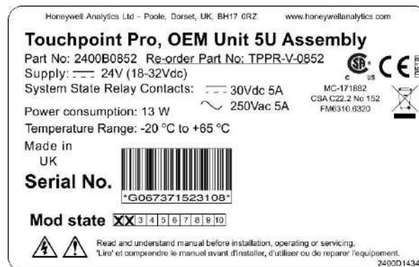
Рисунок 7. Типичная паспортная табличка TPPR
