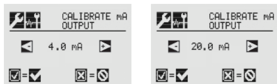
Рис. 220. Экраны калибровки выхода mA
