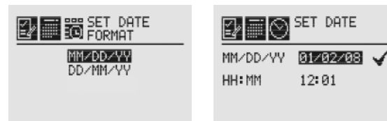
Рис. 69. Экран установки формата даты/меню установки даты
