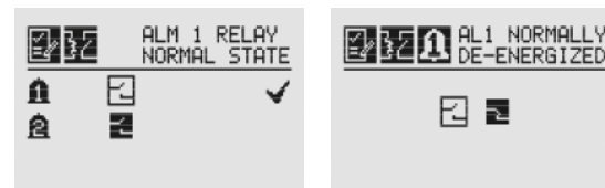
Рис. 132. Текущее состояние реле сигнализации 1 и установка нового состояния
