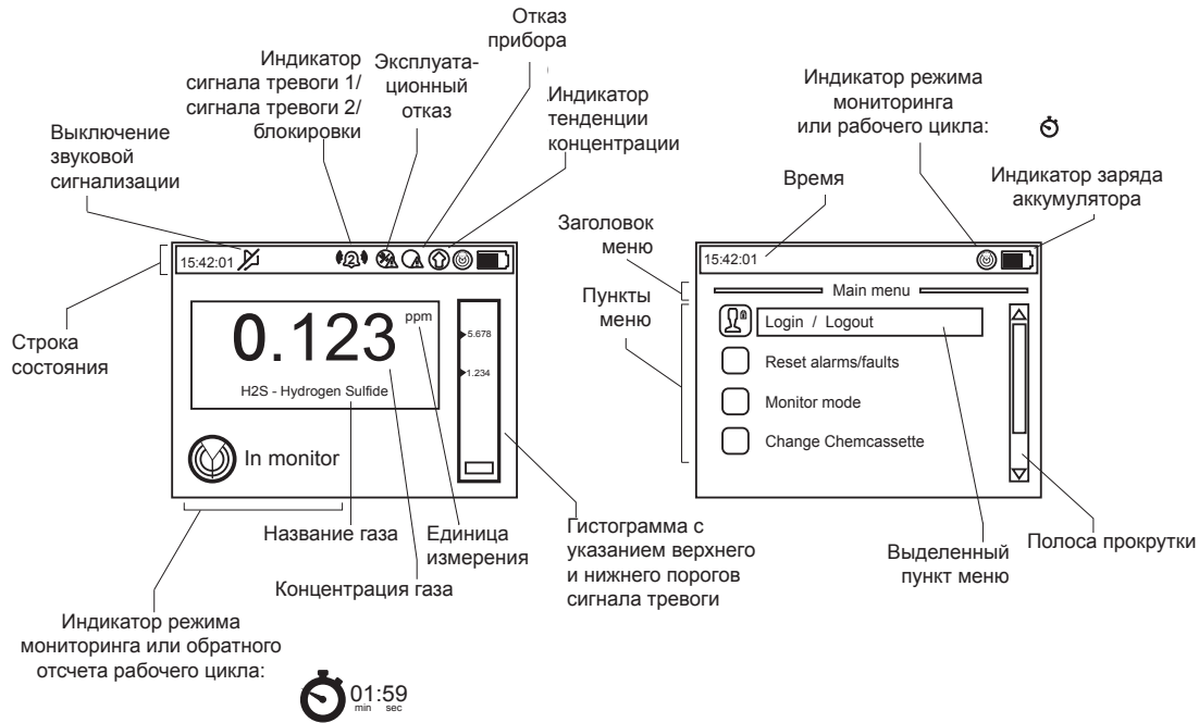
Рис. 6. Элементы типичных экранных форм, отображаемых на дисплее SPM Flex
