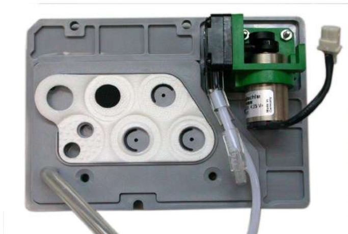
Рис. 7-6. Насос для отбора контрольных проб на перегородке
