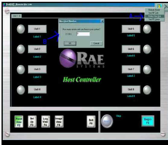
Рис. 3. Advanced Tools (Расширенные инструменты) >> Define Max Unit (Определить макс. количество устройств). Выберите Define Max Unit (Определить макс. количество устройств) на панели Advanced Tools (Расширенные инструменты) и перейдите к выбору количества устройств, с которыми контроллер будет пытаться установить связь (В).
