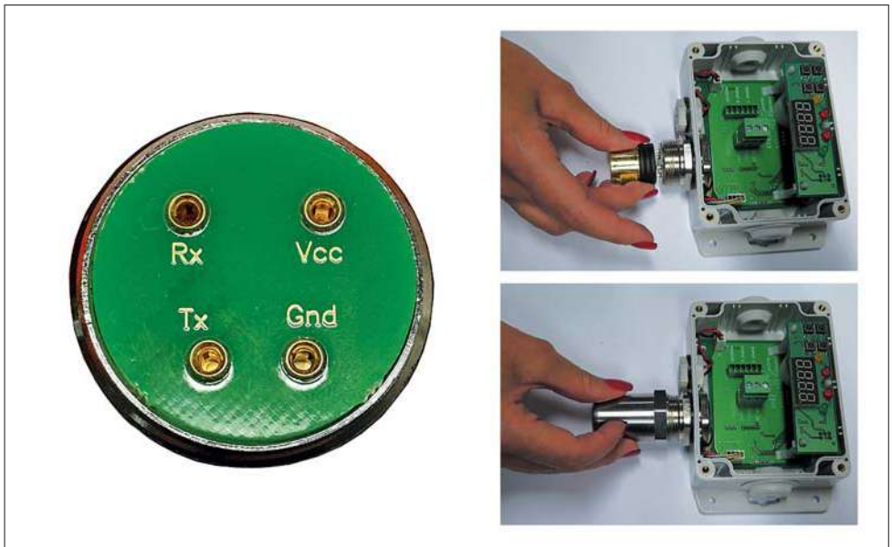
Рис.4. Подключение интеллектуального сенсорного модуля
