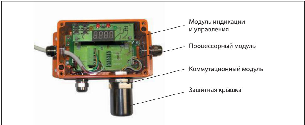
Рис.3. Основные узлы газоанализатора "Сенсон-СВ" моделей 5022 и 5023
