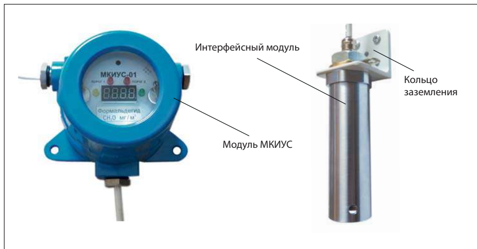
Рис.3. Удаленное подключение интерфейсного модуля с ИСМ
