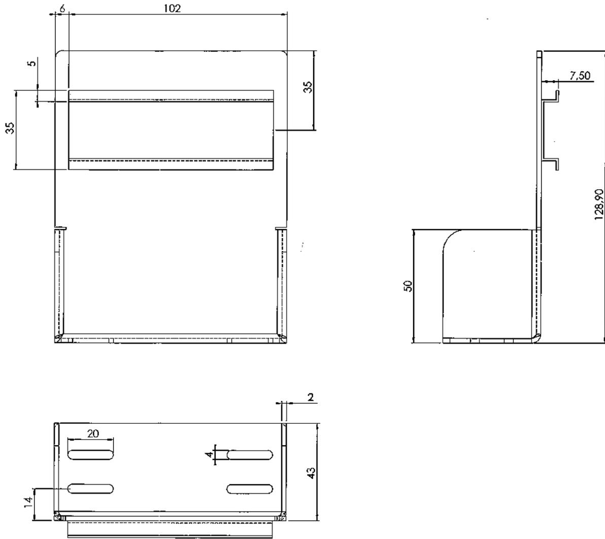
Дополнительная L-образная монтажная стойка с планкой стандарта DIN
