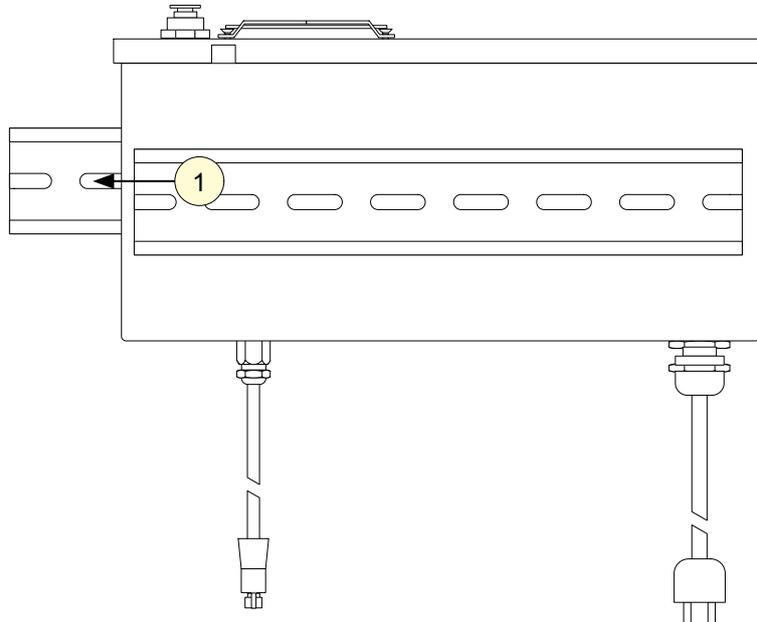
2. Надвиньте экстрактивный модуль ХТ на рейку перед пиролизирующим модулем ХТ, см. рис. 5.
