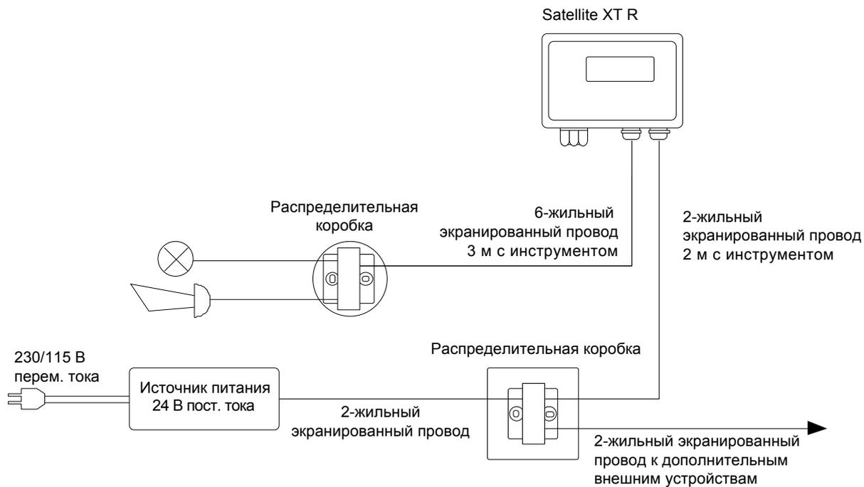
Схема подключения Satellite XT R - базовая конфигурация.
