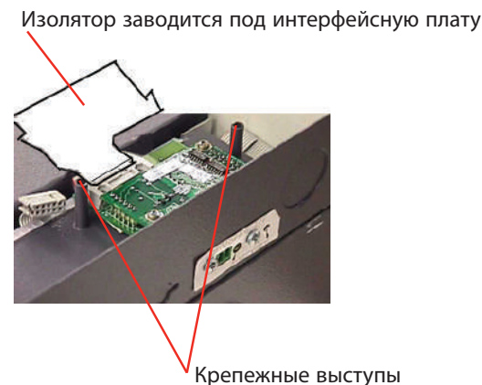
Рис. G-4. Монтаж изолятора
